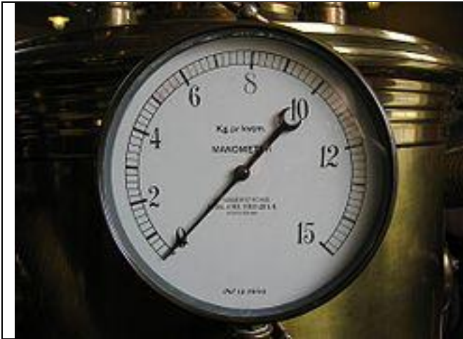
Manometro a quadrante. Scala in \text{kg/cm}^2 .
