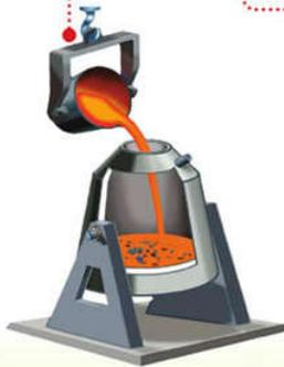
3 Viene soffiato dall'alto, attraverso una lancia, dell'**ossigeno puro** a forte pressione, in modo da rimescolare il metallo liquido. L'ossigeno brucia il carbonio e gli altri elementi presenti nella ghisa e la trasforma in acciaio.
