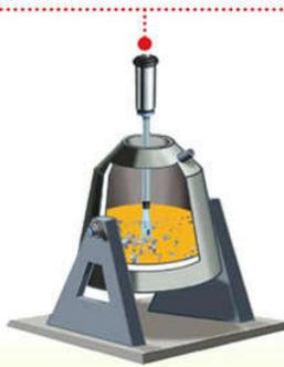
4 La reazione è molto violenta e sviluppa un grande calore che fonde la carica solida e innalza la temperatura dell'acciaio fino a 1600°C. L'acciaio fuoriesce in forma di **colata**.
