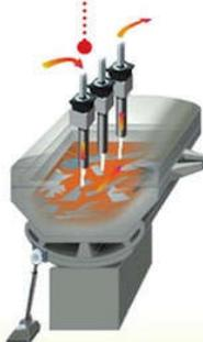
3 L'energia elettrica si trasforma in calore e fonde la carica metallica solida. Si possono raggiungere temperature molto elevate, sino a 2800°C. La **colata dell'acciaio** viene raccolta in un recipiente.
